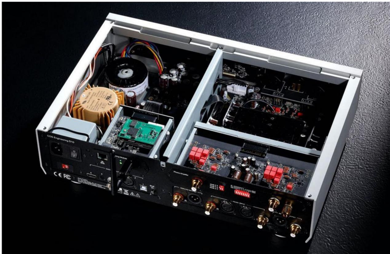
présence de systèmes d'isolation galvanique ainsi que d'une flopée de relais Nexem Japan, de condensateurs au polypropylène, de résistances à faible tolérance. Tout a été pensé et optimisé dans les moindres détails. Voyons maintenant si cela porte ses fruits en matière de restitution sonore.
